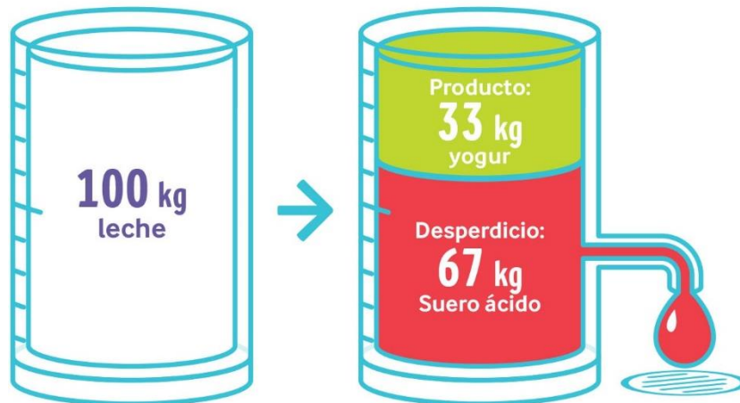
Figura 1. Proceso tradicional de yogur griego concentrado
